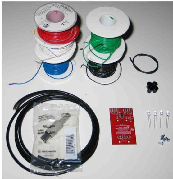
Environs 2 mètres (ou plus selon besoin mais maximum 5 mètres) de câble 6 conducteurs non blindé (exemple référence Radiospares 660-4049) et une prise DIN 6 broches MAS60.
