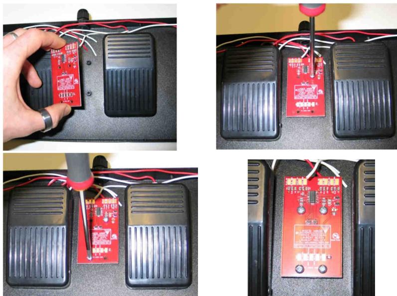
Une fois la carte en place, installez la coque supérieure équipée des diodes électroluminescentes à côté de la coque inférieure.
