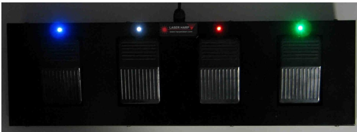
Un appui sur la pédale devant éteindre la diode correspondante, indiquant la prise en compte de l'action.
