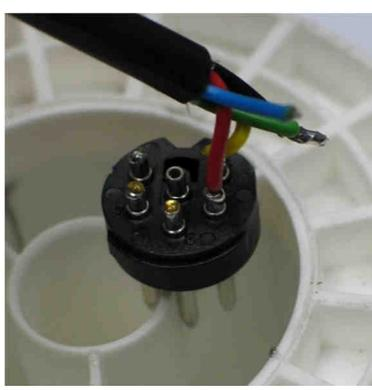
Le fil blanc et le contact « 3 », le fil bleu et le contact « 4 » et enfin les fils noir et vert et le contact « 5 »
