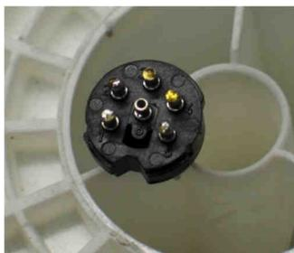
Prenez le câble d'une main et présentez le fil jaune devant le contact « 1 » et réalisez une soudure rapide pour ne pas faire fondre le support de contact.
